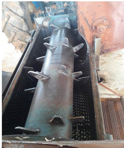
Figura 2- Interior de uma Trilhadora estacionária
