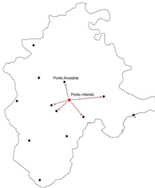
Figura 12: Esquema da dependência espacial do interpolador IDW.
