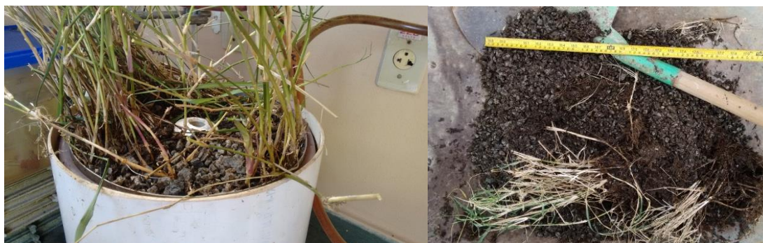
Figura 7.9. Imagens da amostra de SAC vertical alimentado com esgoto bruto e lixiviado do SAC vertical alimentado com lodo de fossa séptica.
