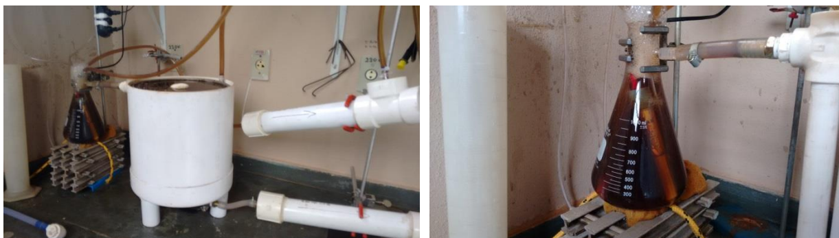
Figura 7.43. Foto do teste realizado em março de 2016 com SACV alimentado com lodo de fossa séptica 11/03/2016.
