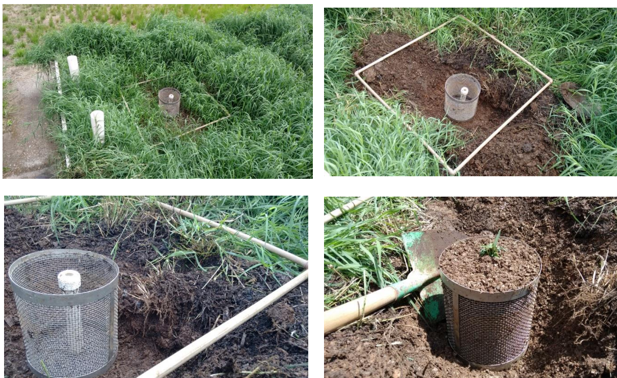
Figura 7.10. Imagens do processo de obtenção de amostra do SAC vertical alimentado com lodo de fossas sépticas.
