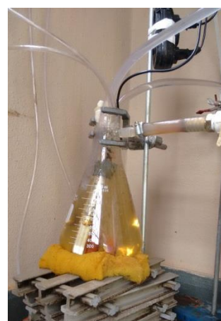
Figura 7.41. Foto do teste realizado em março de 2016 com SACV alimentado com esgoto bruto 01/03/2016
