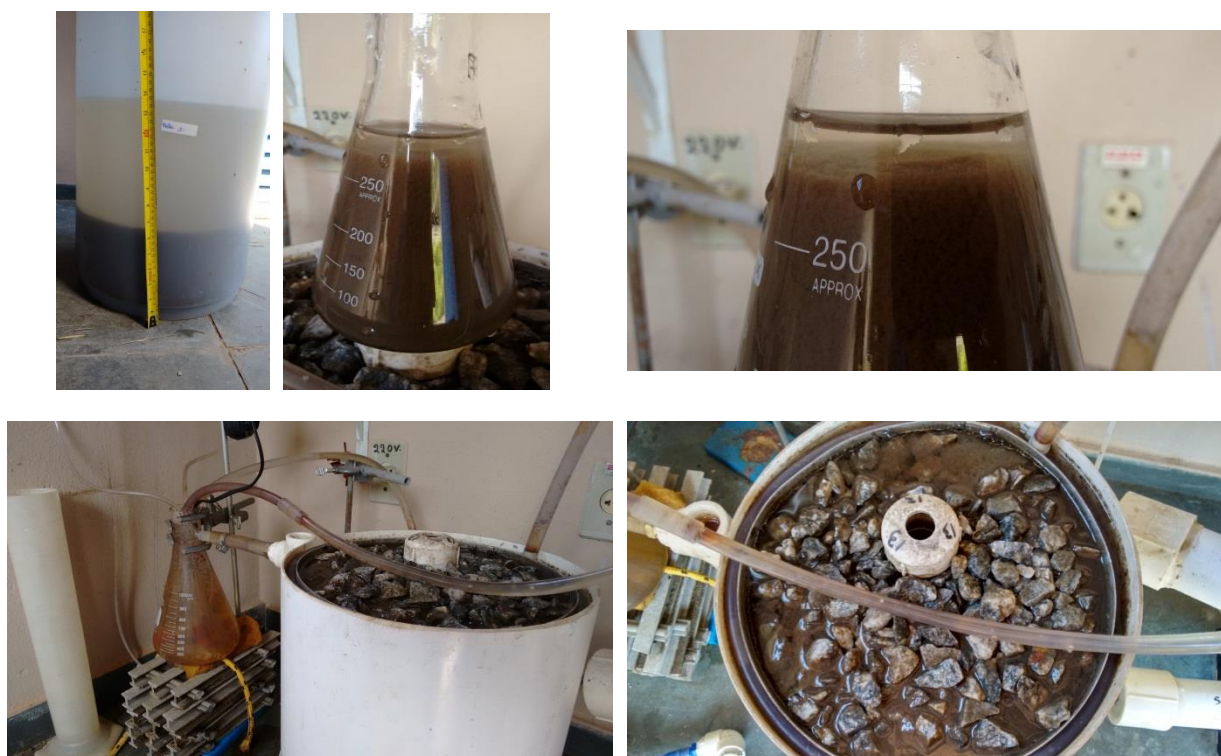
Figura 7.11. Imagens do lodo ativado inoculado ao respiômetro.
