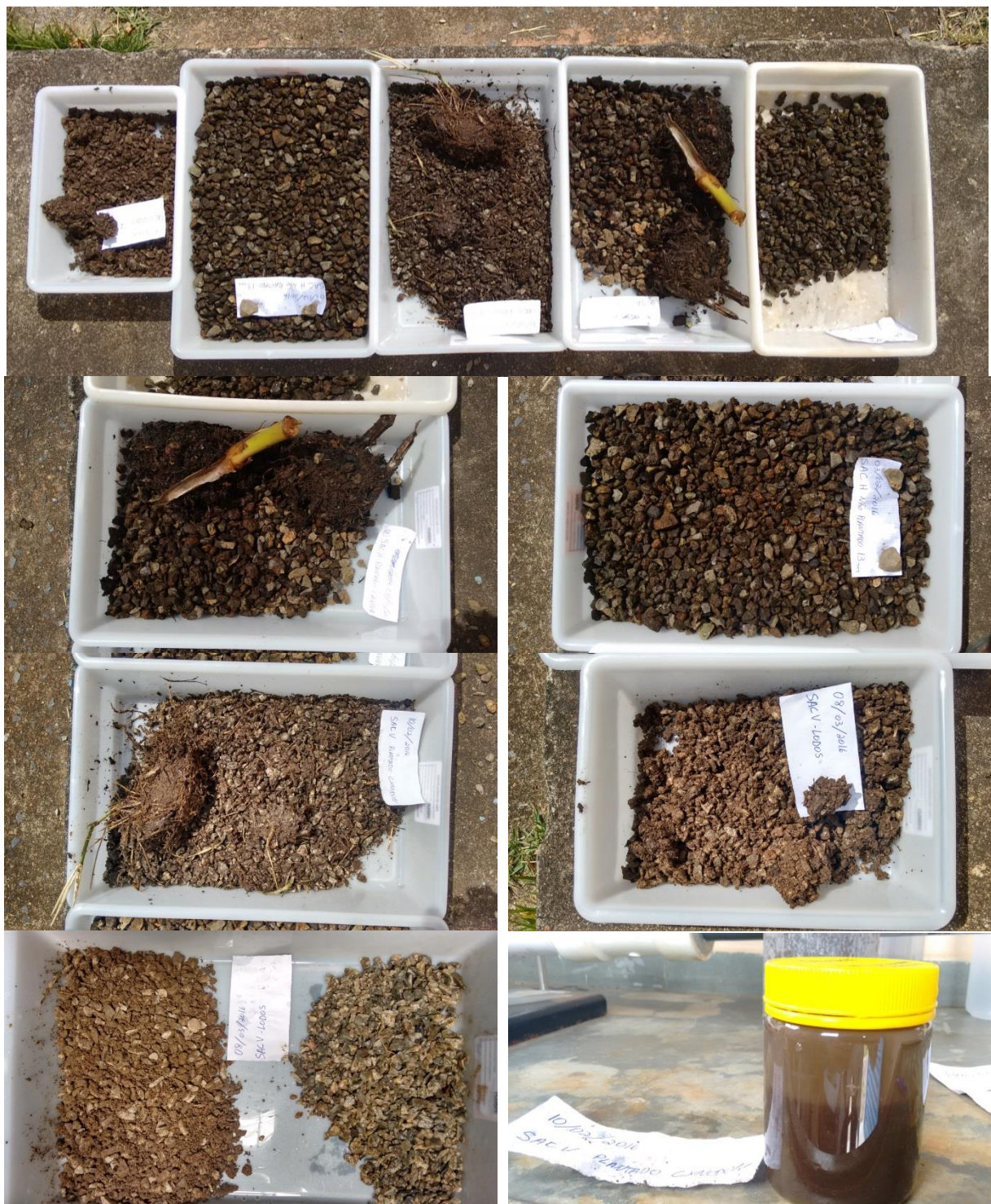
Figura 7.12. Imagens das amostras obtidas dos meios suportes investigados e procedimento para remoção do material aderido.
