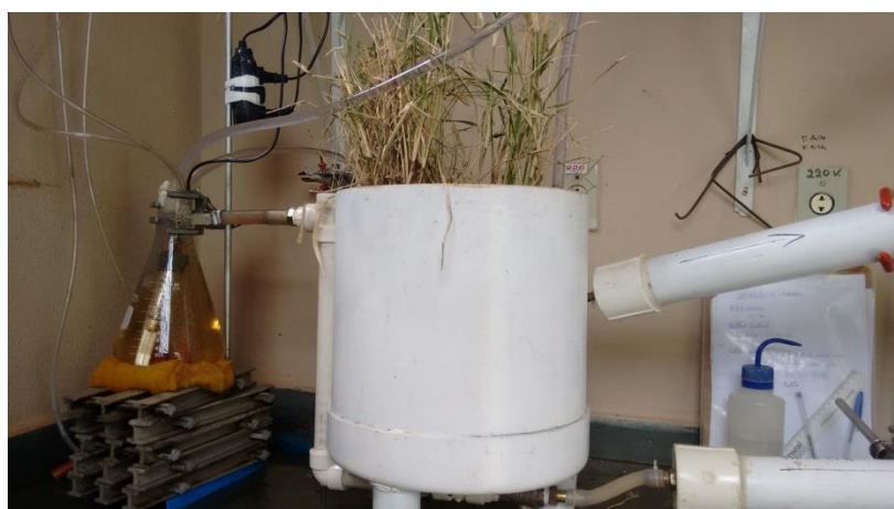
Figura 7.41. Foto do teste realizado em março de 2016 com SACV alimentado com esgoto bruto 01/03/2016
