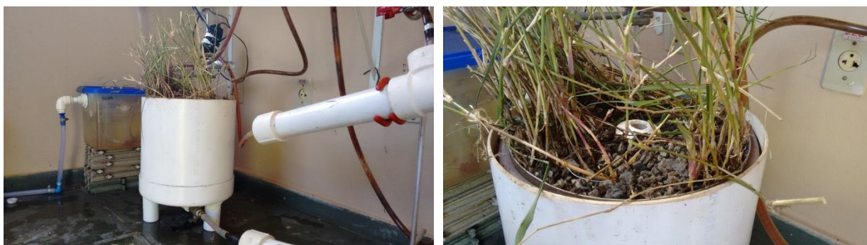
Figura 7.42. Foto do teste realizado em fevereiro de 2016 utilizando amostra do SACV alimentado com esgoto bruto (03/02/2016).
