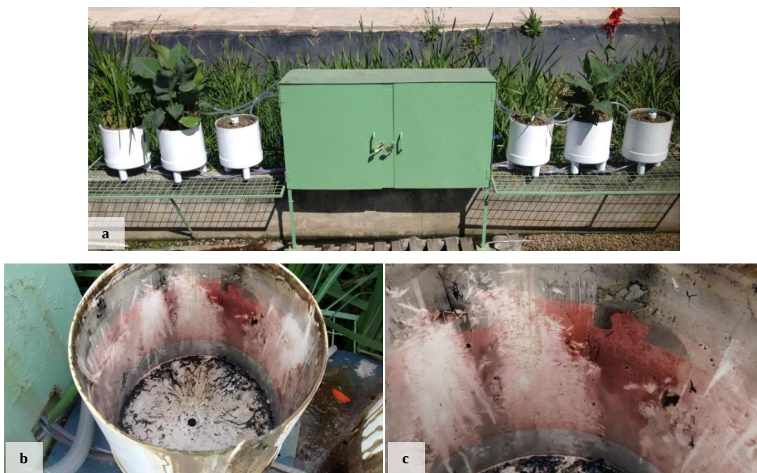
Figura 6.15. Reatores instalados em campo (a) e biofilme com coloração púrpura no interior do PFR não plantado do transecto a 23 m (b e c).
