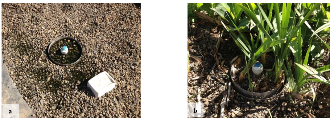
Figura 6.12. Cestas móveis no leito original na região de saída (23 m da entrada), não plantada (a) e plantada (b).
