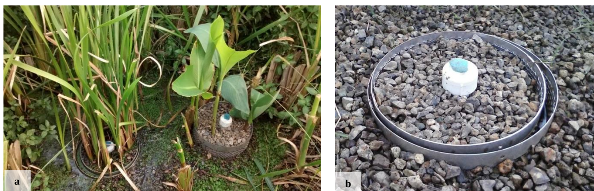
Figura 6.4. Cestas plantadas com Typha latifolia e Canna x generalis (a) ambientando no leito do SAC plantado; e cesta não plantada (b) ambientando no leito do SAC não plantado.
