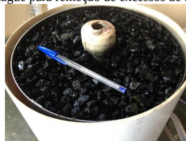
3) Instalação da cesta no reator
