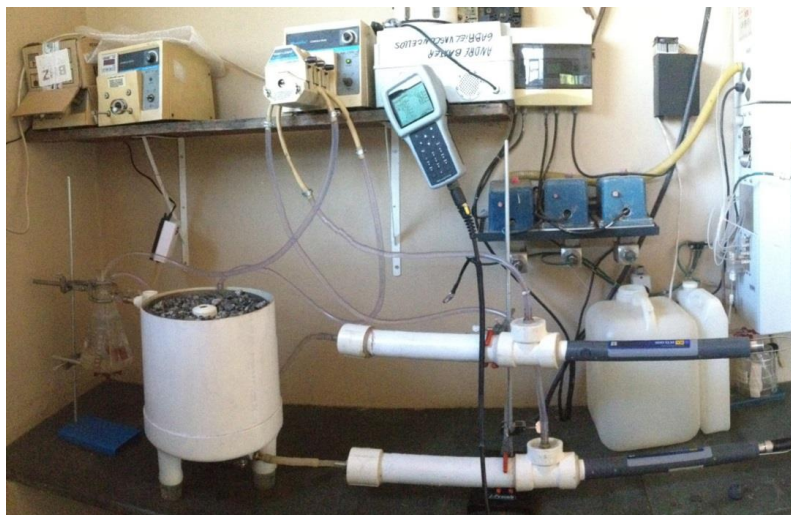
Figura 7.7. Imagem do aparato experimental utilizado para o teste de aeração. Data da imagem: 17/04/2015.
