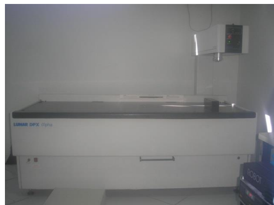
Figura 7. Densitômetro de dupla emissão de raios X (DXA) modelo DPX-ALPHA LUNAR.
