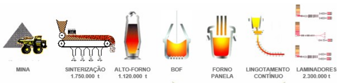
Figura 3.1 - Fluxograma de Produção da ArcelorMittal Monlevade (CHAVES,2006 Adaptado.)
