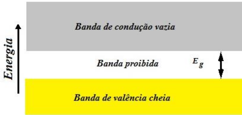
Figura 3.5 – Diagrama de bandas de um semiconductor intrínseco. Adaptação: (KITTEL, 2006)
