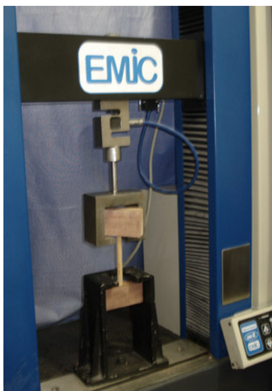
Figura 3.6 Configuração geral do ensaio de arrancamento e posicionamento do CP
