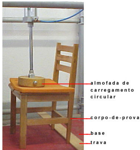
Figura 3.23 Configuração geral do ensaio de carregamento de fadiga no assento da cadeira
