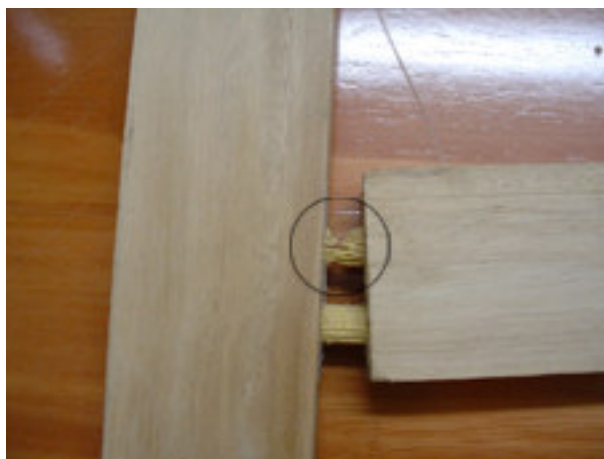
Figura 4.14 Ruptura da cavilha
