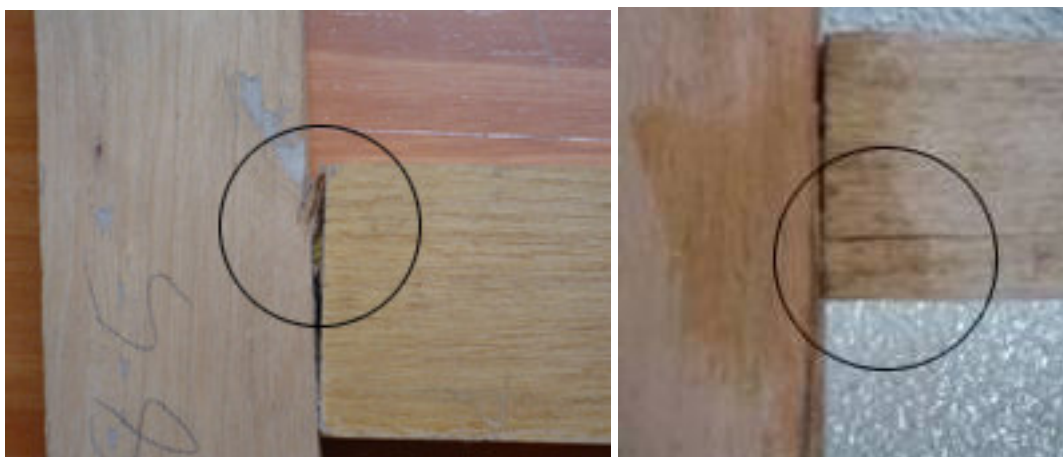
Figura 4.15 Ruptura no lado superior do montante e rachadura paralela às fibras da travessa
