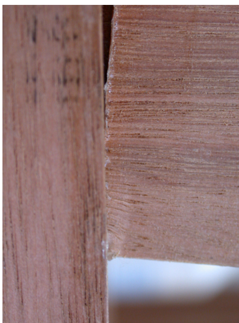
Figura 4.18 Esmagamento no lado inferior da travessa (ocorrido em vários CPs)
