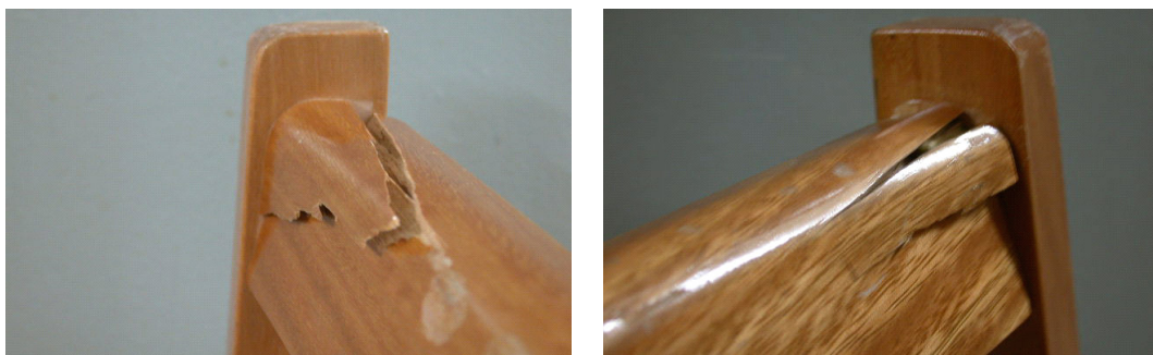
Figura B.3 Rupturas no encosto da cadeira ocorrido no ensaio de queda
