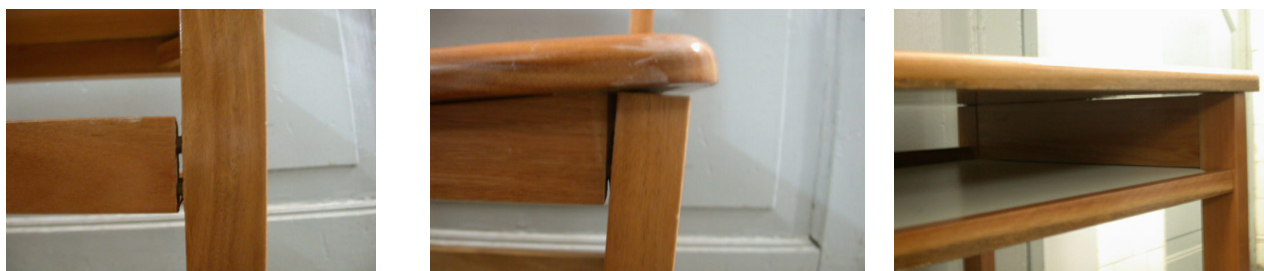
Figura B.4 Afrouxamento de ligações ocorridas no apóia-pé da cadeira, na trava do assento e afrouxamento no tampo da mesa
