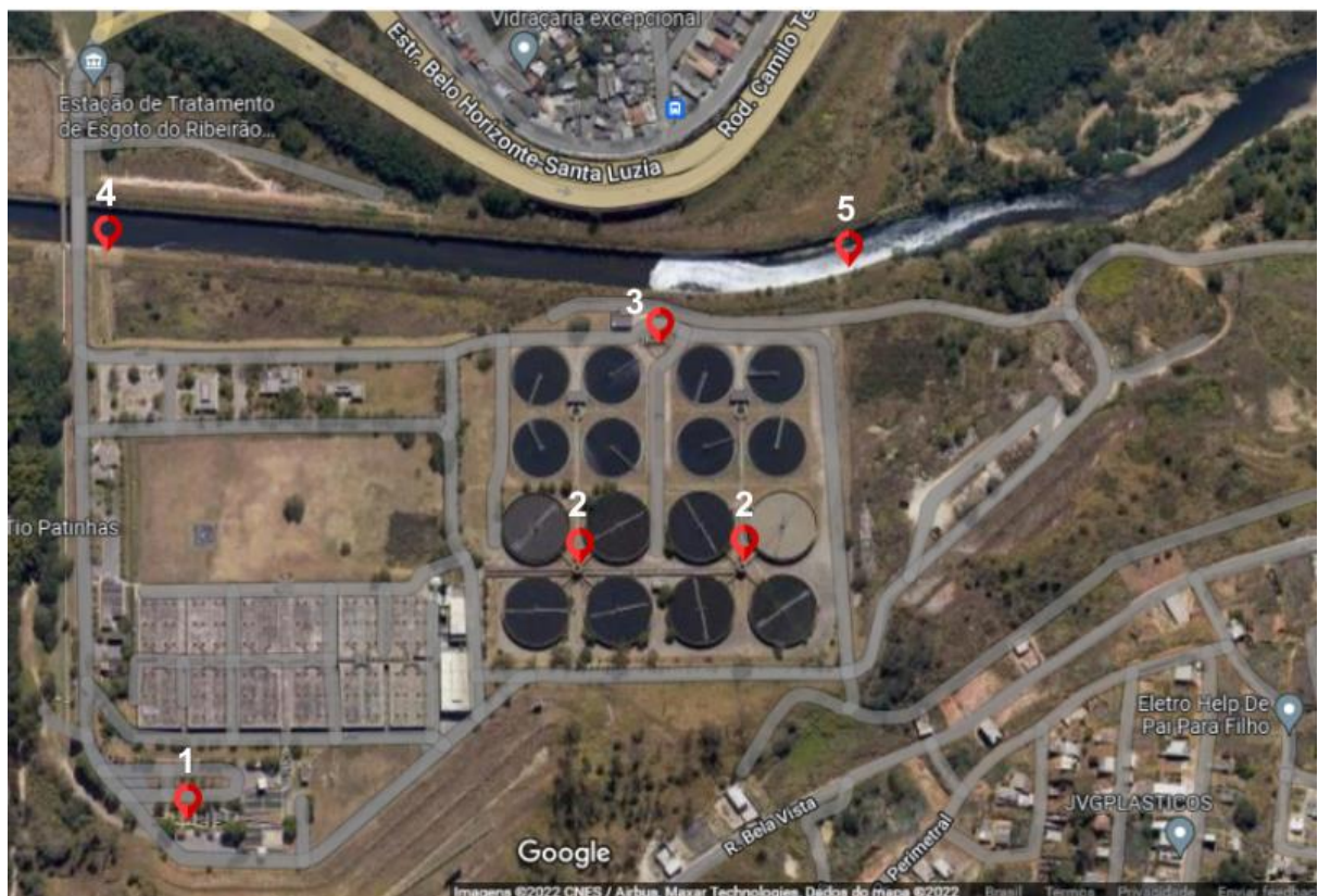
Figura 2 - Estação de Tratamento de Esgoto do Ribeirão Onça vista de cima e pontos de amostragem. Imagem de satélite, Google Maps. Ponto 1: Tanque de entrada - EB. Ponto 2: Saída do tratamento anaeróbio - UASB. Ponto 3: Saída do decantador secundário - ET. Ponto 4: Corpo
