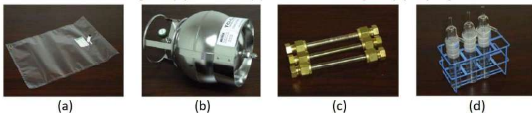
Figura 7 - Principais metodologias de amostragem de siloxanos presentes no biogás: (a) sacos de amostragem; (b) canister ; (c) tubos de adsorção; (d) impingers
