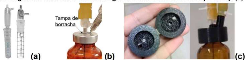
Figura 28 – Destaque para os tubos de entrada e saída de gás e encaixe esmerilhado do impinger (a); local de inserção das agulhas (b); suporte para agulhas do sistema de amostragem de siloxanos em matriz gasosa utilizando frascos tipo crimp (c)
