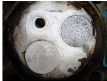
Figura 6 - Deposição de \text{SiO}_2 na cabeça do cilindro de motor a gás causada pela oxidação de siloxanos, após mais de 3500 h de operação
