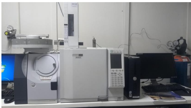
Figura 11 - Cromatógrafo a gás acoplado a espectrometria de massas, Shimadzu QP 2010-Plus.
