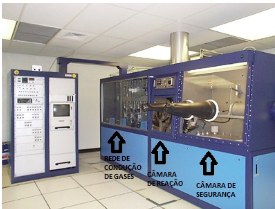
Fig 1.4 - Foto de um reator de MOCVD. As três câmaras estão indicadas.
