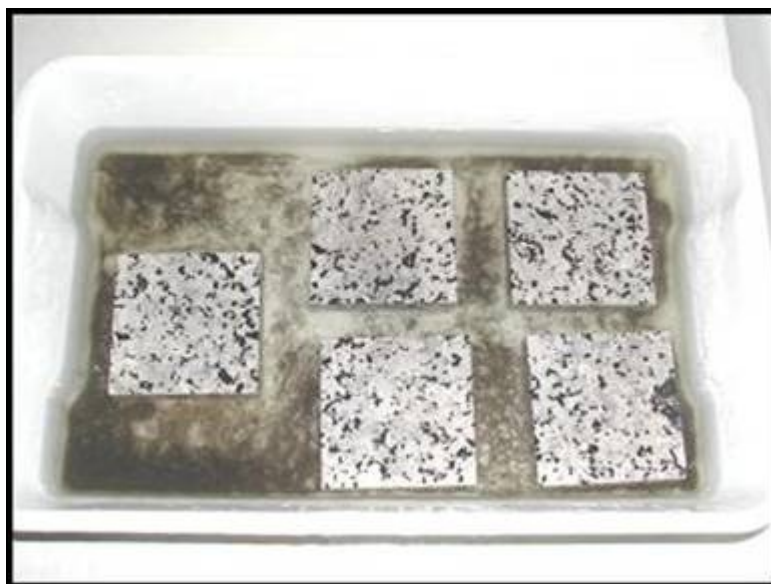
Figura VII.5: Corpos de prova de granito comercial Ás de Paus no ensaio de cristalização de sais por imersão total.
