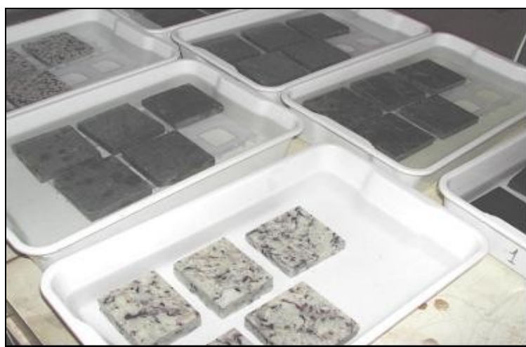
Figura VII.1: Disposição dos corpos de prova de granitos e esteatitos em recipientes com solução de \text{HNO}_3 e \text{H}_2\text{SO}_4 no ensaio de lixiviação estática.
