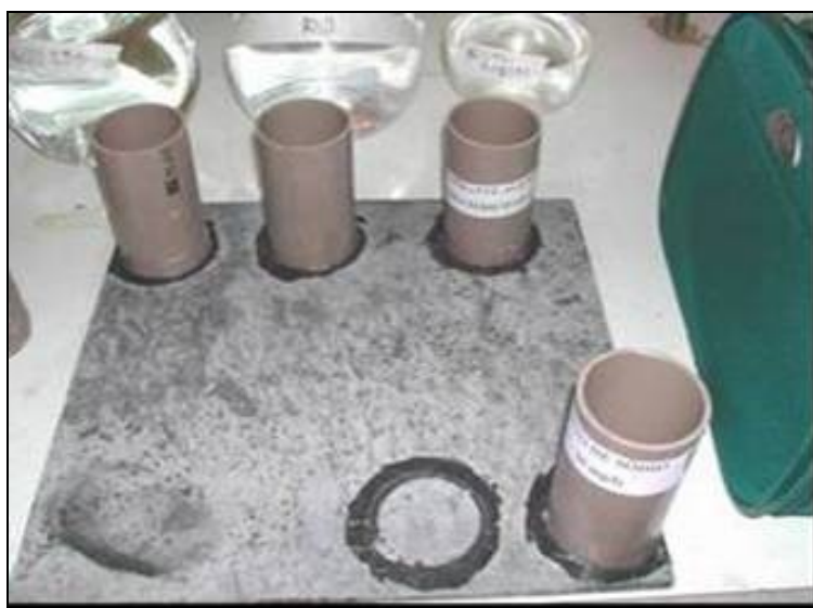
Figura VII.6: Disposição dos tubos de PVC durante ensaio de resistência ao ataque químico em placas polidas de esteatito.
