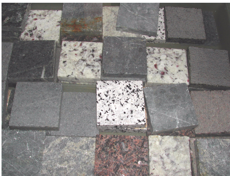
Figura VII.8: Disposição dos corpos de prova após ensaio de choque térmico
