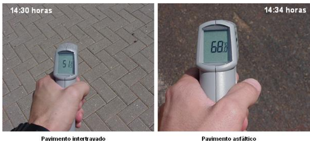
Figura 6.11 - Medição realizada por Idário Domigues em Ribeirão Preto/Ago 2001 (ABCP, 2004)
