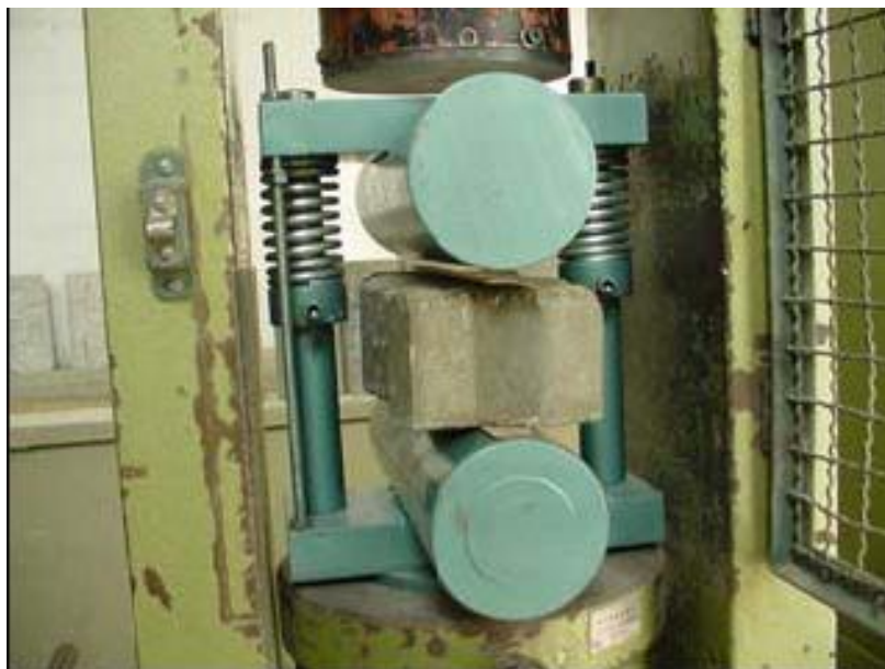
Figura 4.5 - Dispositivo de ensaio de tração, utilizado em ensaios de resistência (CRUZ, 2003)
