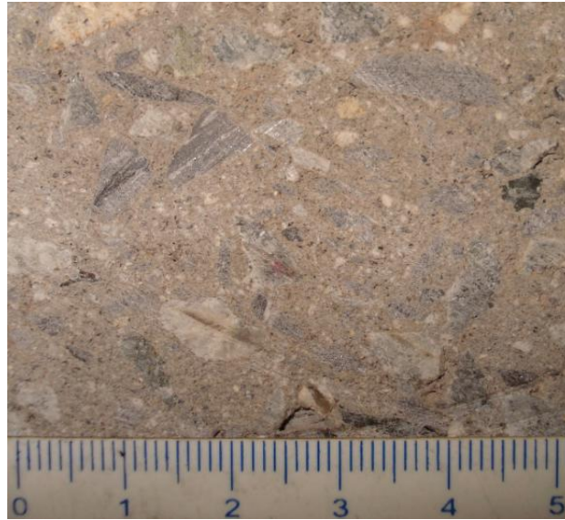
Figura 5.15 - Superfície da peça de concreto para pavimentação intertravada adquirida no mercado, após o ensaio de abrasão (ABI-ACKEL, 2009).
