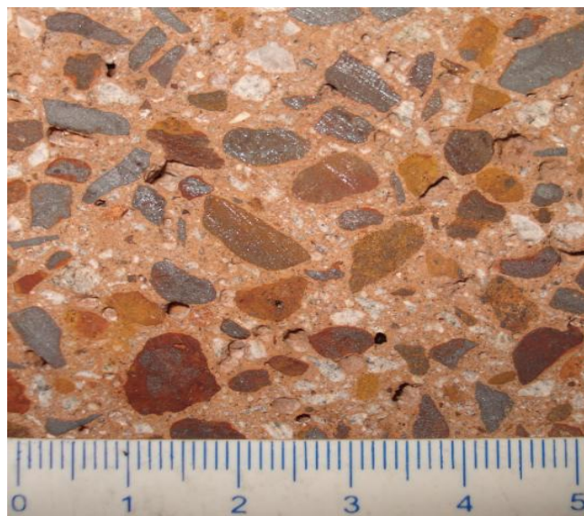
Figura 5.16 - Superfície da peça vinda de Brumadinho/MG, após o ensaio de abrasão (ABI-ACKEL, 2009).
