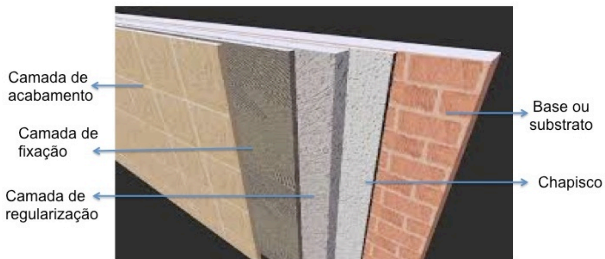
Figura 1 – Partes constituintes do revestimento cerâmico aderido (JUNGINGER, 2003).
