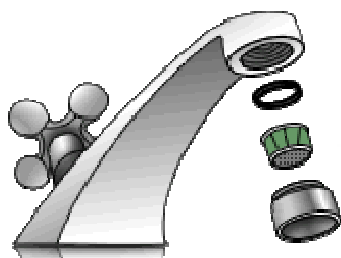
Figura 3.1.5: Esquema de montagem de um arejador
