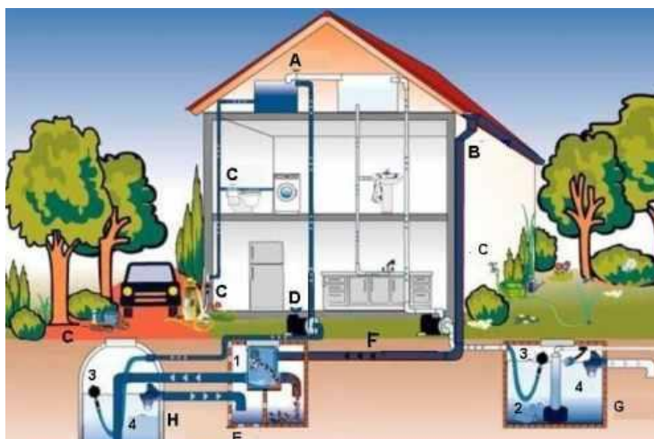
Figura 4. Sistema de captação e armazenamento da água de chuva
