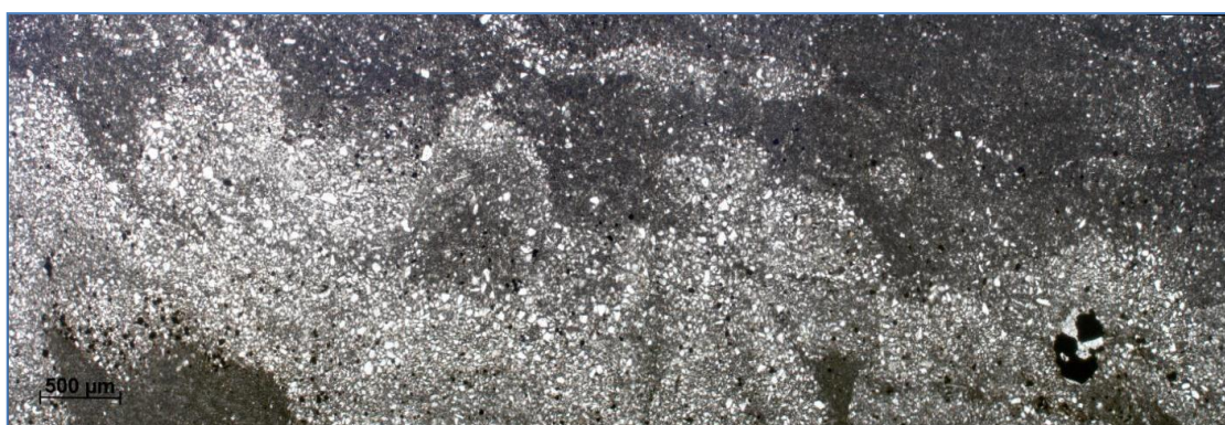
Figura 4.68: Fotomicrografia panorâmica de rocha pelito arenosa, mal selecionada (presença de pelo menos três classes granulométricas), mostrando acamamento deformado e grande contribuição de opacos (nicóis paralelos, aumento 2.5X, zoom 4X. Lâmina CSA070).
