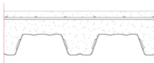
Figura 12 - Disposição da armadura de fissuração
