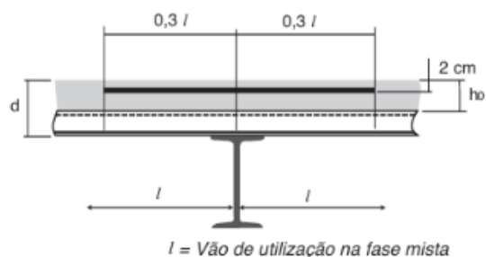
Figura 10 - Disposição da armadura negativa
