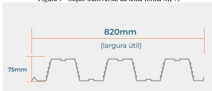
Figura 9 - Seção transversal da telha fôrma MF75
