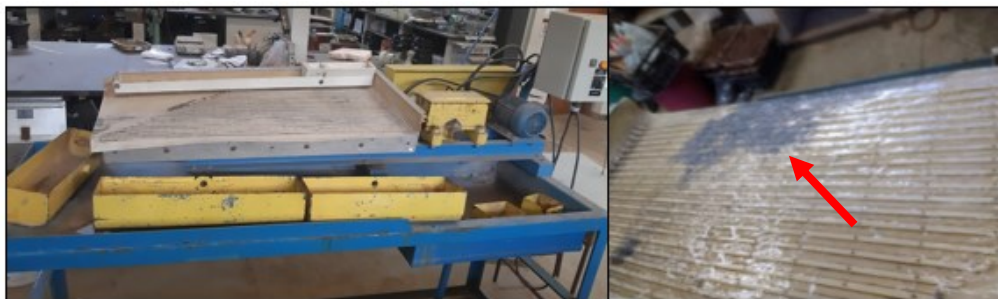
Figura 42: Ensaio mesa concentradora modelo Wilfley e material concentrado obtido
