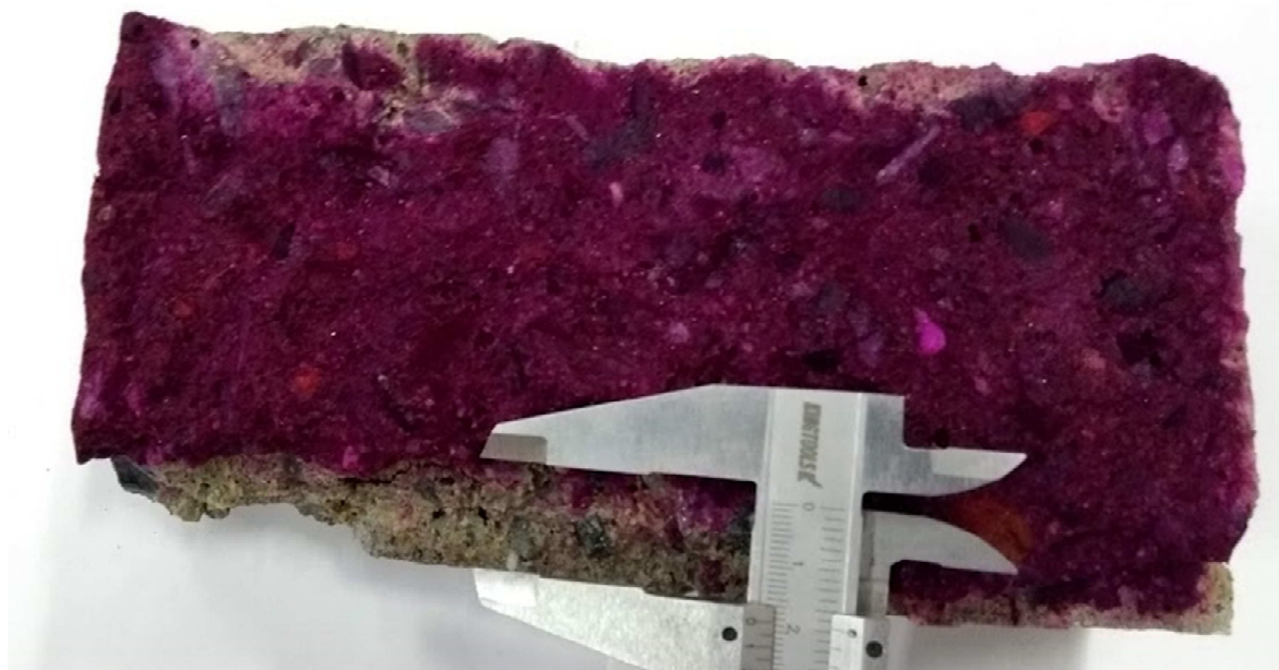
Figura 23 – Corpo de Prova aspergido com fenolftaleína
