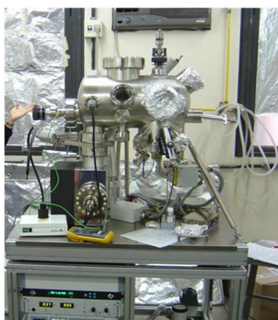
Figura 5.5: À esquerda: STM-UHV do laboratório de nanoscopia de ultra-alto-vácuo do DF-UFMG. À direita: arranjo para a montagem da amostra.
