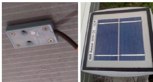
Figura 3.4 – Sensor de temperatura Pt100 e célula fotovoltaica Si-p para coleta da irradiância solar global e temperatura de célula respectivamente.
