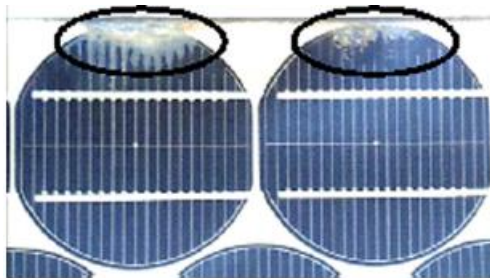
Figura 1.6 - Módulo FV com descolamento. Fonte: Ndiaye et al. (2013).
