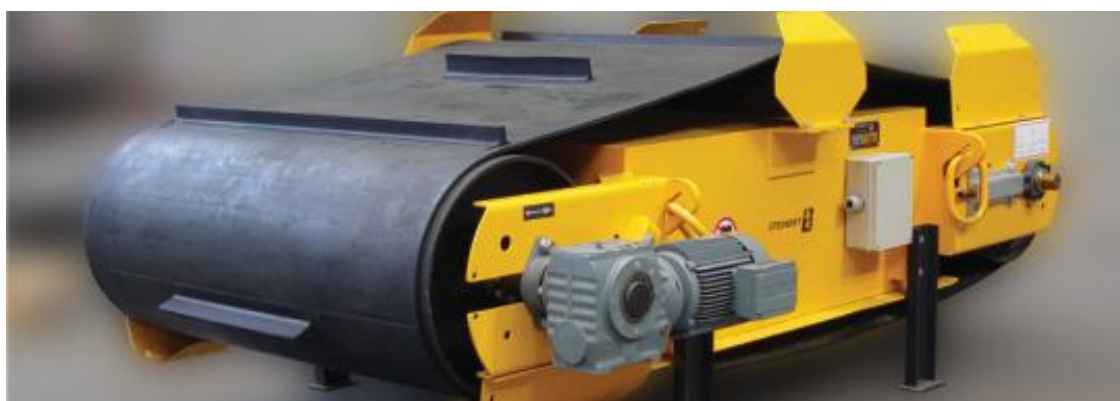
Figura 3.6 - Separadores magnéticos de baixa intensidade. Fonte: STEINERT, 2012.
