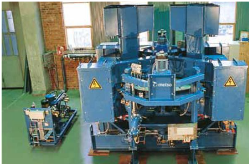
Figura 3.10 - Separadores magnéticos de alto gradiente HGMS. Fonte: METSO, 2014.
