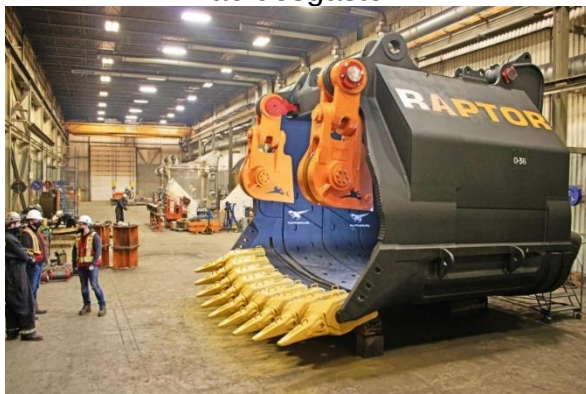
Figura 2 – Implemento construído com materiais fundidos, estruturais, e resistentes ao desgaste.
