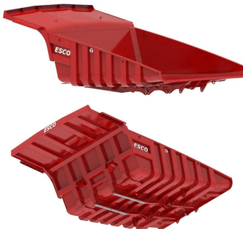
Figura 7 - Implemento com aplicação de aços estruturais.
