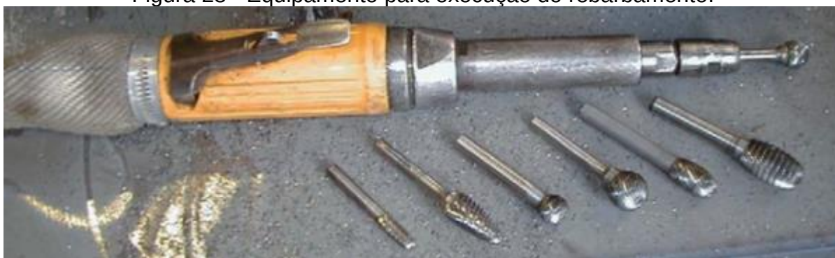
Figura 28 - Equipamento para execução do rebarbamento.
