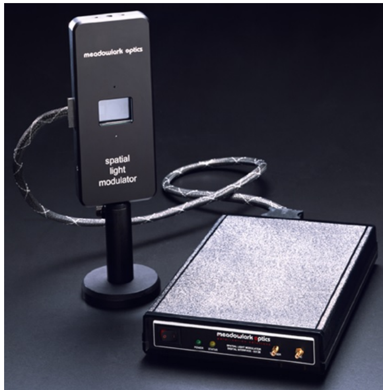
FIGURA 4.9: Foto do SLM da empresa Meadowlark, modelo D3128.
