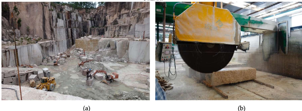
Figura 3 – Etapas primárias de beneficiamento: Extração (a) e corte (b) de Blocos de Granito na Jazida
