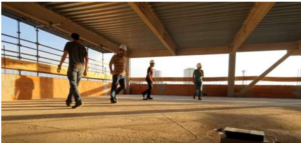
Figura 111 – Realização de ensaios complementares para a avaliação da influência do número de pessoas na resposta dinâmica do piso.
