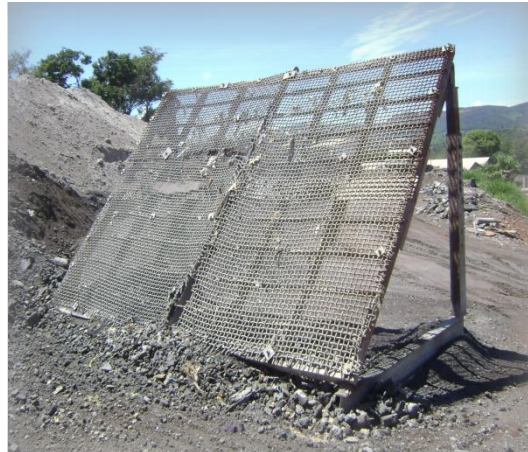
Figura 30 - Peneira para separação da escória de aciaria bruta
