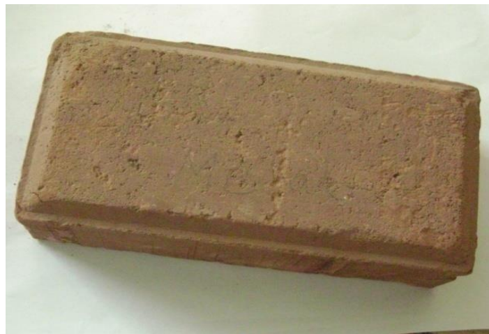
Figura 47 - Piso de rejeito de minério de ferro - Construcom
