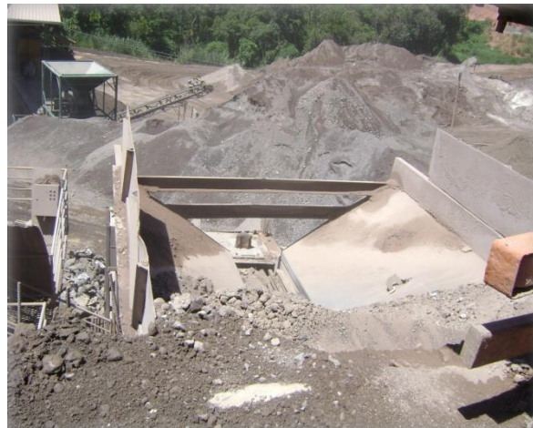
Figura 31 - Britador da escória de aciaria
