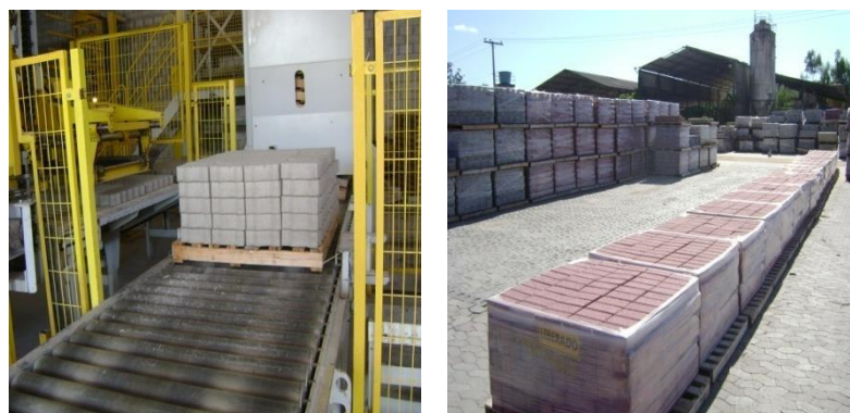
Figura 40 - Paletização dos pisos intertravados
