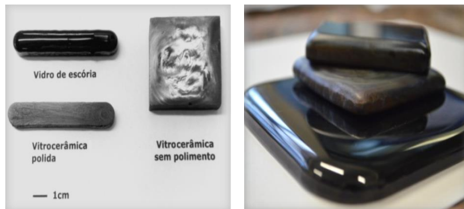
Figura 28 - Produção de vitrocerâmicas com escória de aciaria da Usiminas
