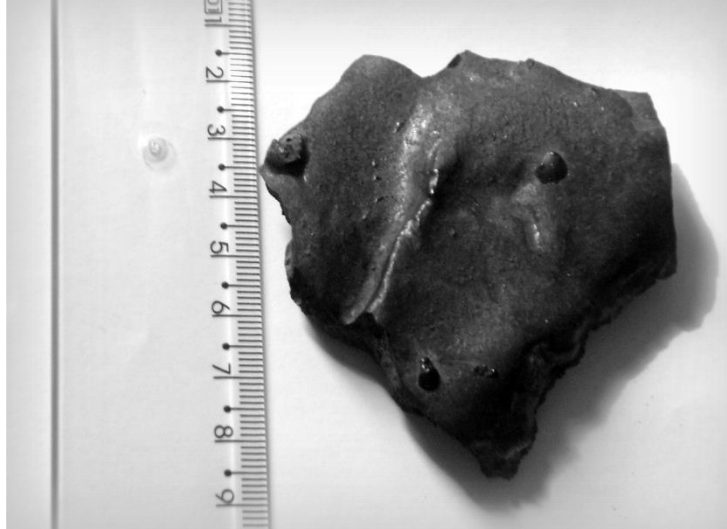
Figura 26 - Amostra de escória de aciaria fornecida do pátio 02
