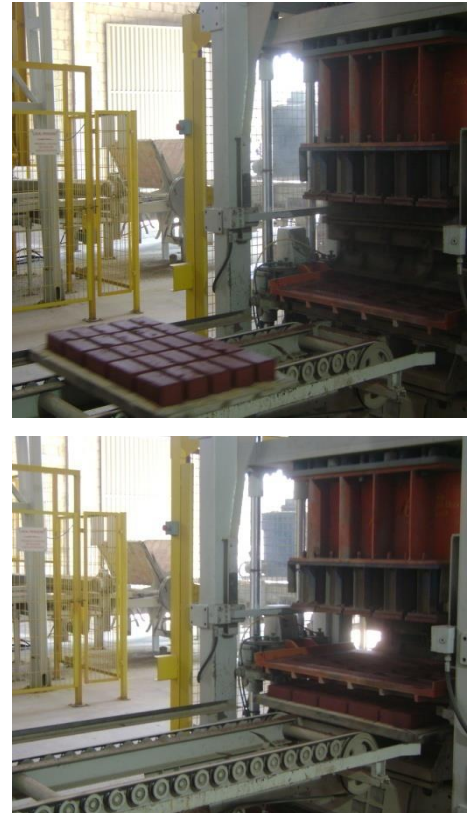
Figura 38 - Presangem dos pisos
