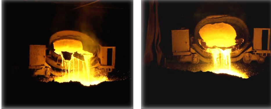
Figura 24 - Despejo da escória líquida no pátio 02
