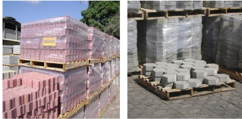
Figura 41 - Pátio de estocagem dos pisos intertravados
