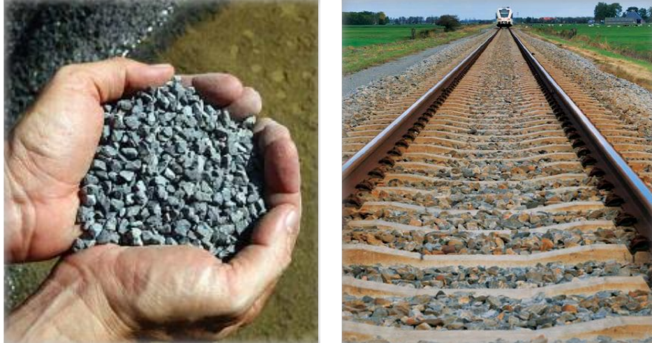
Figura 29 - Agregado siderúrgico Usiminas aplicado em lastro ferroviário
