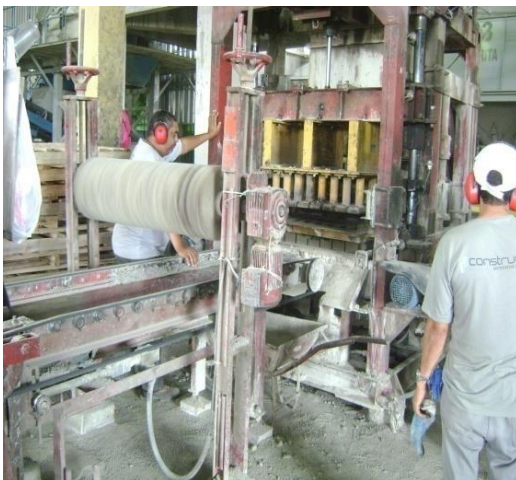
Figura 45 - Prensa hidráulica de pisos
