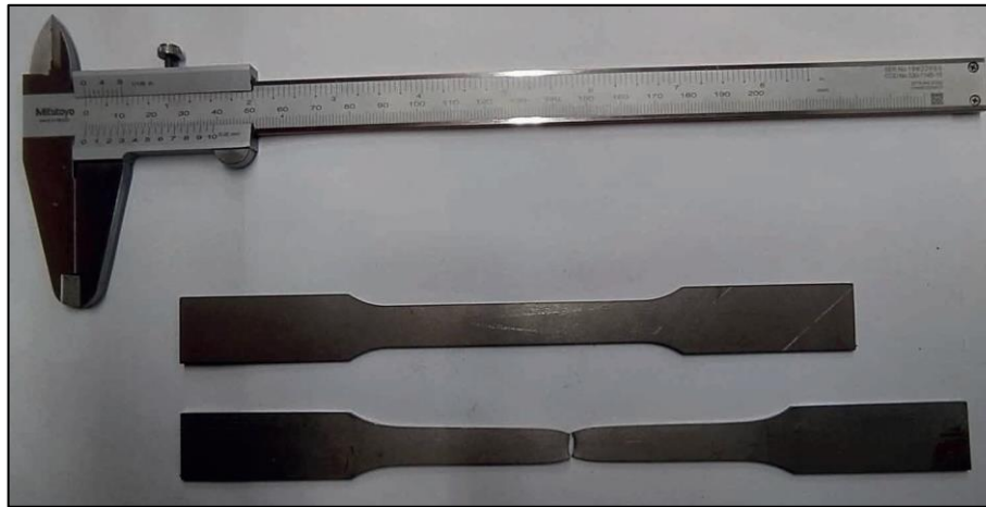
Figura 2.23 Comparativo dimensional dos corpos de prova antes e depois do ensaio de tração.
