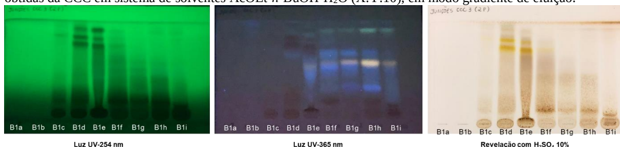
FIGURA 69 – Cromatografia em camada delgada das subfrações resultantes da purificação da subfração B1, obtidas da CCC em sistema de solventes AcOEt- n -BuOH-H 2 O (X:Y:10), em modo gradiente de eluição.
