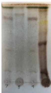
FIGURA 61 – Cromatografia em camada delgada das frações 7 a 10 obtidas por HSCCC, a partir da fração apolar do extrato EtOH R de C. lineatifolia .
