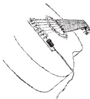
FIGURA 5: Captação por vibração do tampo ou rasteiro (captador piezoelétrico)
