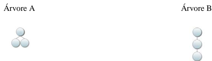
Figura 7-3 – Ambas as árvores têm três nós. Entretanto, o somatório do número de nós de todas as subárvores é diferente: para a árvore A é 5 = 3 + 1 + 1 e para a árvore B é 6 = 3 + 2 + 1 .
