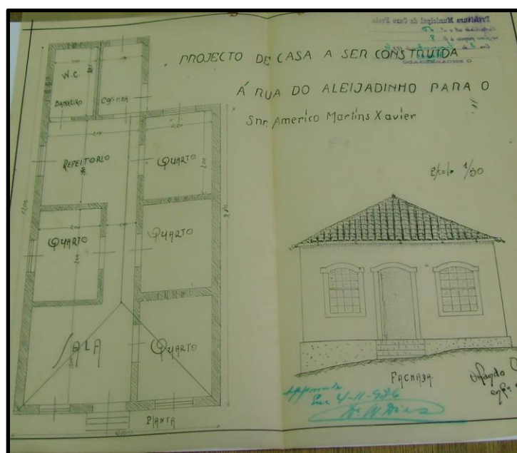
FIG.21. Projeto de construção de uma casa. 1937.
