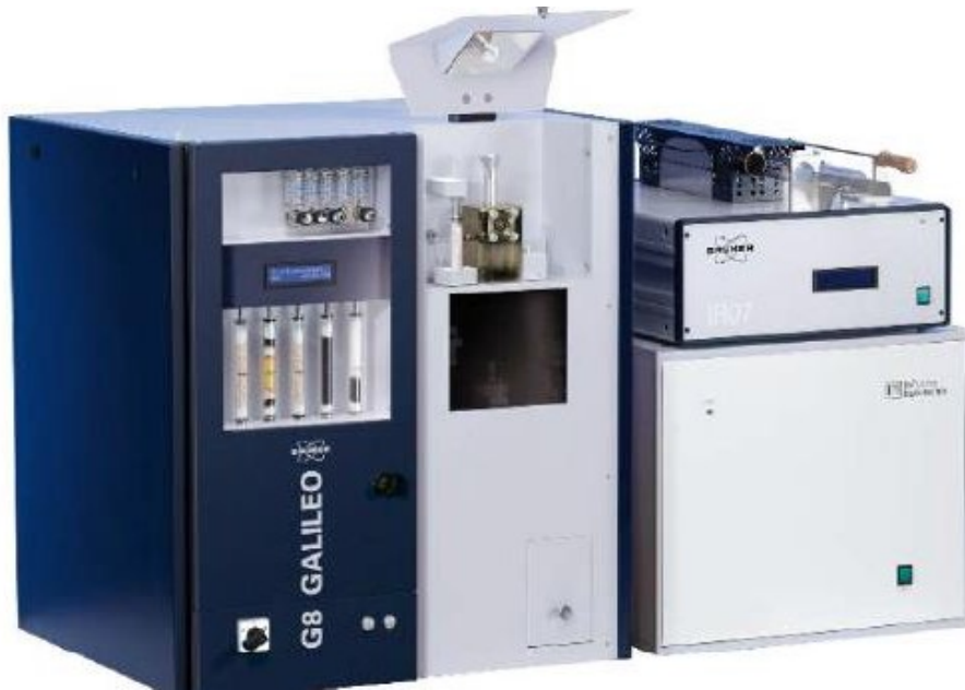
Figura 4.7. Analisador de hidrogênio da Bruker G8 Galileo, com forno para extração do hidrogênio difusível Bruker IR07 e espectrômetro de massas.
