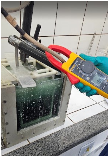
Figura 4.5. Medição da corrente obtida ao final da eletrogalvanização de cada face.
