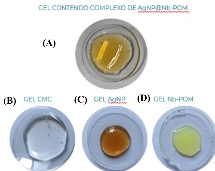
Figura 17 - Aspecto visual dos hidrogéis obtidos: (a) contendo o complexo híbrido AgNP@Nb-POM (b) base padrão contendo somente CMC (c) contendo AgNPs e (d) contendo Nb-POM.
