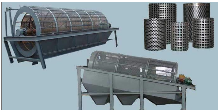
Figura 7 - Exemplo de peneira rotativa (trommel) utilizadas na classificação de minérios.
