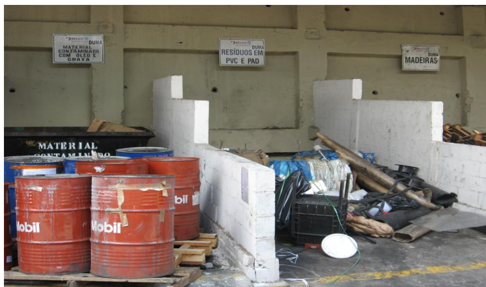
Figura 47 – Detalhe do armazenamento de resíduos: 1º box - material contaminado com óleo e graxa; 2º box - PVC e PAD; 3º box – madeiras Fonte: Belgo Bekaert, 2007
