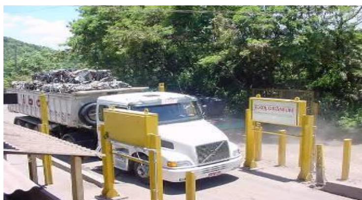
Figura 27 - Portal GR 526 (proteção radioativa)
