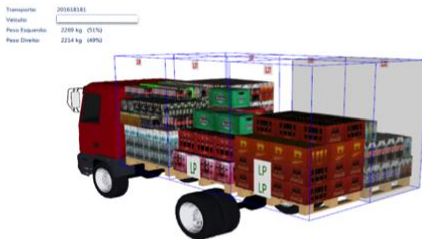
Figura 6: Distribuição dos paletes no caminhão.
