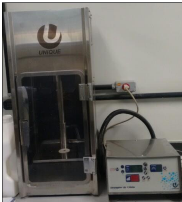
FIGURA 22 - Desruptor de células ou misturador ultrassônico utilizado para homogeneização das soluções poliméricas preparadas de PVdF.
