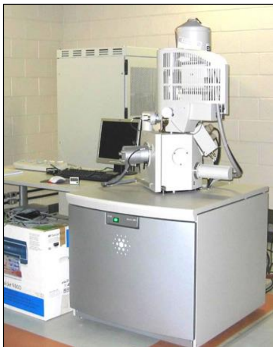
FIGURA 24 - Microscópio Eletrônico de Varredura FEG - Quanta 200 FEI. FONTE - ÁVILA JÚNIOR, 2010.
