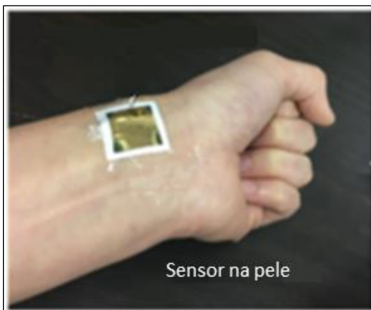
FIGURA 12 - Sensor produzido a partir de nanofibras de PVdF, capaz de monitorar a pulsação do sistema cardiovascular.
