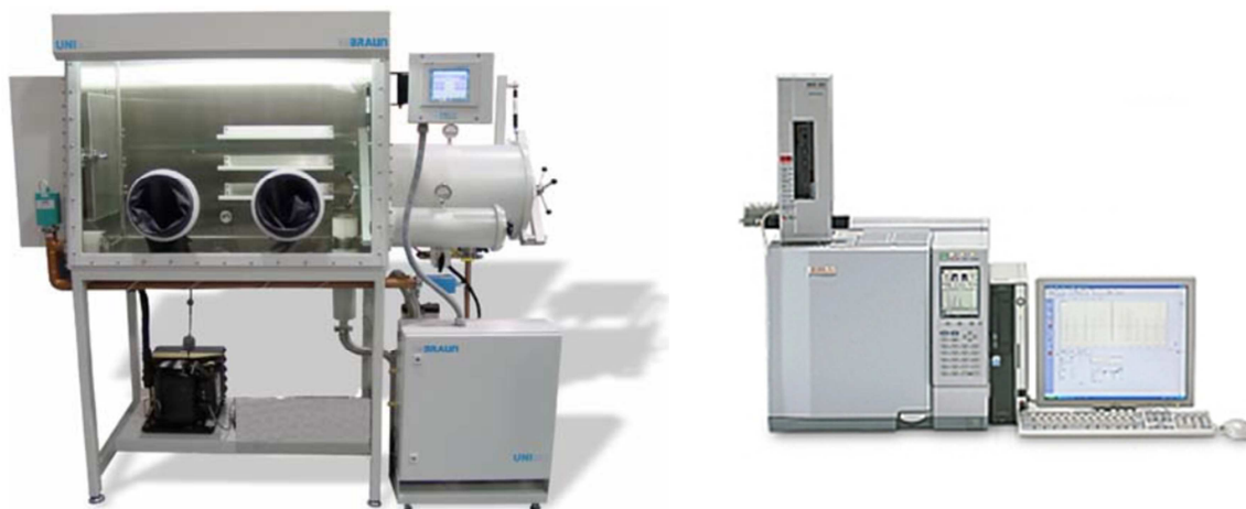
Figura 24 – Caixa de Luvas MBraun ® (esquerda) utilizada para estocagem dos reagentes e solventes e cromatógrafo a gás SHIMADZU GC-2010 (direita) para avaliação da pureza dos solventes.
