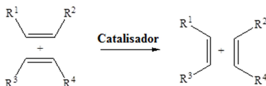
Figura 2 - Reação de metátese de alquenos. [19]
