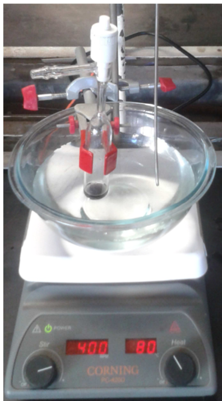
Figura 25 – Sistema para montagem das reações de metátese cruzada em frasco de vidro do tipo Schlenk.
