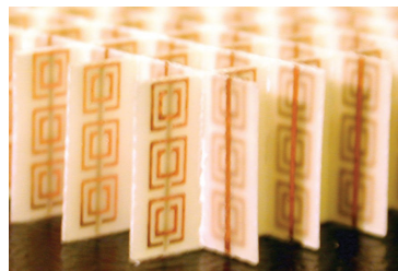
Figura 2.2: Metamaterial criado a partir dos elementos de tiras metálicas (responsáveis pelo \varepsilon < 0 ) e ressoadores em anéis com gap (responsável pelo \mu < 0 ), impressos em lados opostos de placas de circuito impresso, as quais foram encaixadas entre si para formar um sólido [Shelby et al., 2001].
