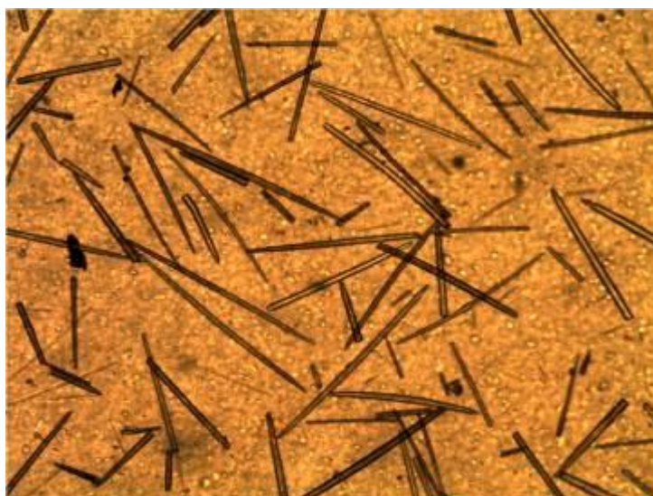
Figura 5.5: Imagem de MO da amostra 0,5% de fibras de espongilito
