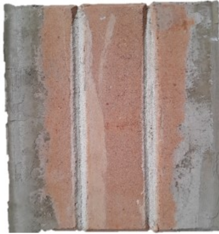
Figura 3.5 – Prisma de alvenaria para o ensaio de cisalhamento.
