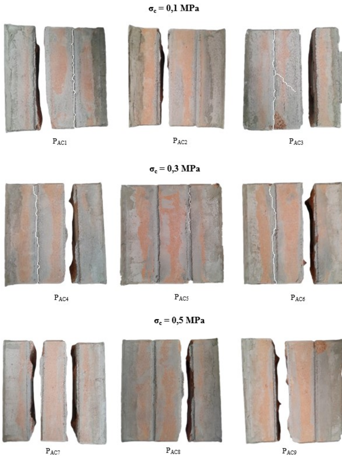
Figura C.1 – Padrões de fissuração dos prismas AC após a ruptura por cisalhamento.
