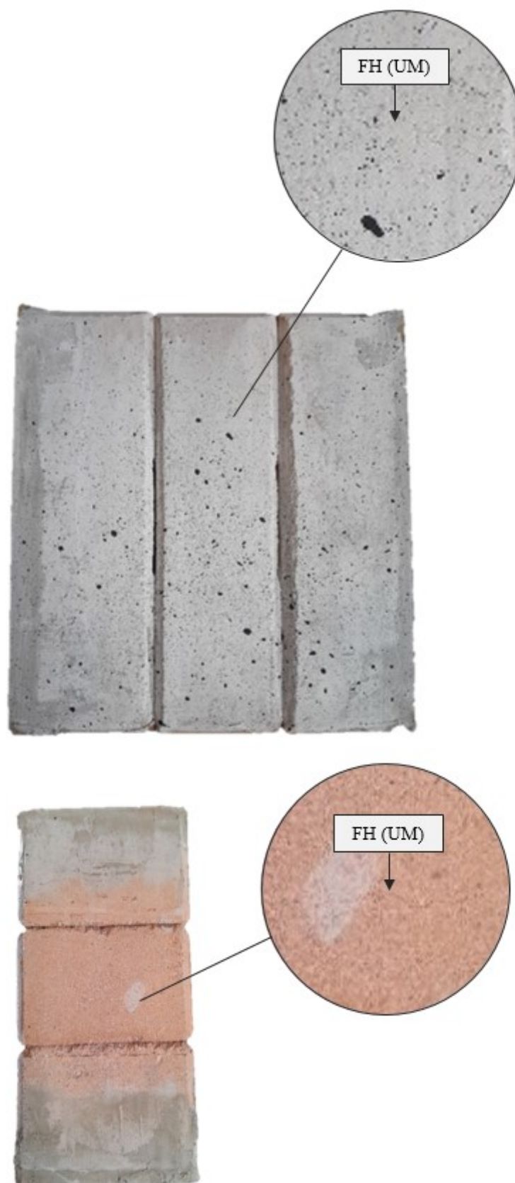
Figura C.24 – Registro detalhado do modo de falha do prisma P CA3 ( \sigma_c = 0,1 MPa), evidenciando fissuras horizontais, FH(UM); sem separação das unidades.
