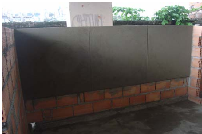
FIGURA 21 - Visão final do painel pronto para os testes no estado endurecido.
