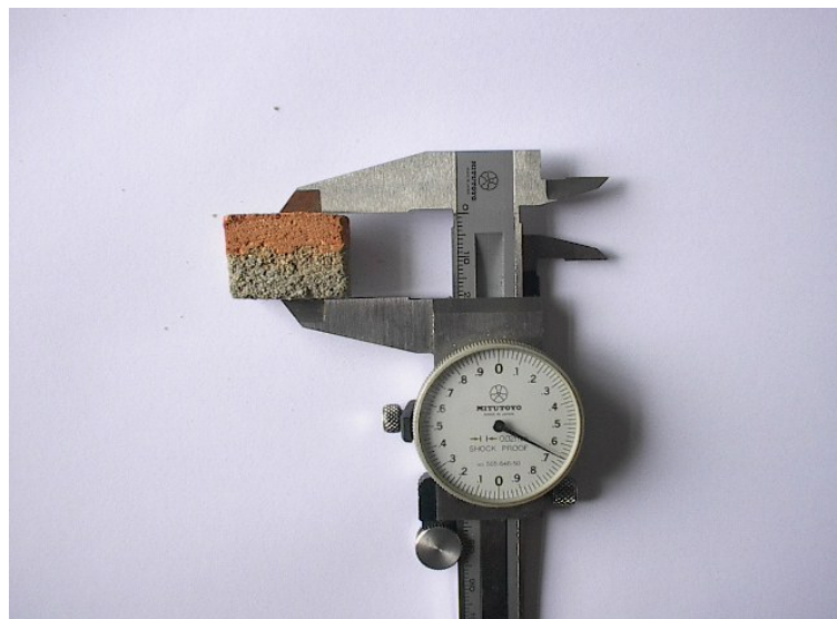
FIGURA 28 - Amostras após redução no gabarito com maquina (não-metalizadas).
