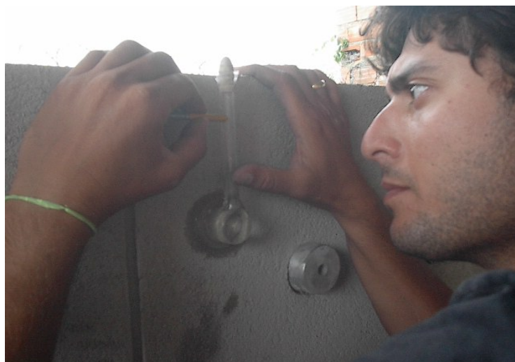
FIGURA 27 - Realização de leitura do ensaio no pescoço graduado do cachimbo.
