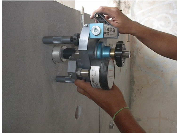
FIGURA 26 - Teste de resistência de aderência.
