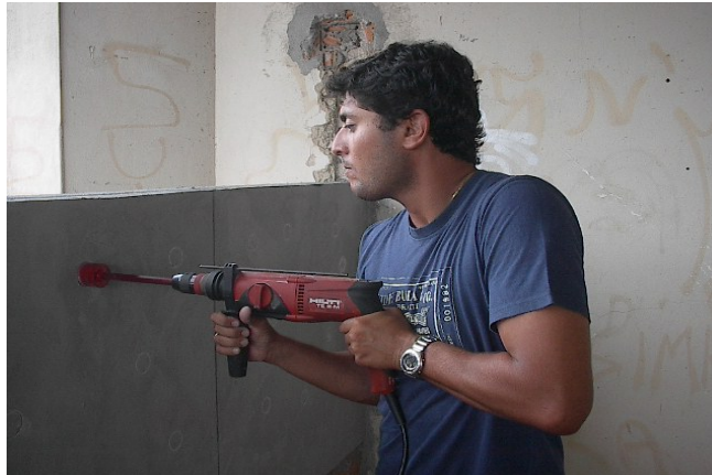
FIGURA 22 - Corte do CP para arrancamento e amostras dos painéis prontos para os testes no estado endurecido.
