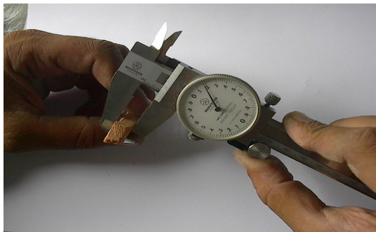
FIGURA 36 - Medidas sucessivas da espessura da amostra para avaliação da espessura da camada retirada por lixamento.
