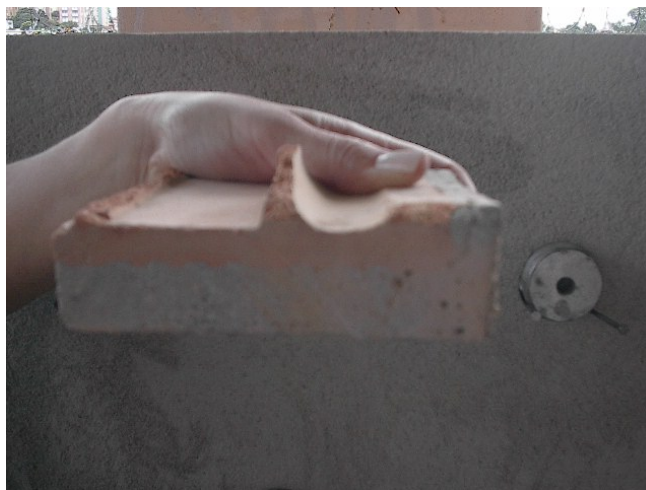
FIGURA 23 - Visão da interface argamassa/substrato a ser estudada.
