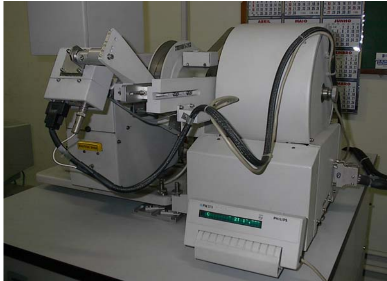
FIGURA 6 - Aparelho para a realização da difração de raios-X (DRX).
