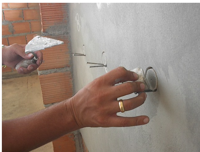
FIGURA 24 - Colagem das placas para o teste de resistência a tração.
