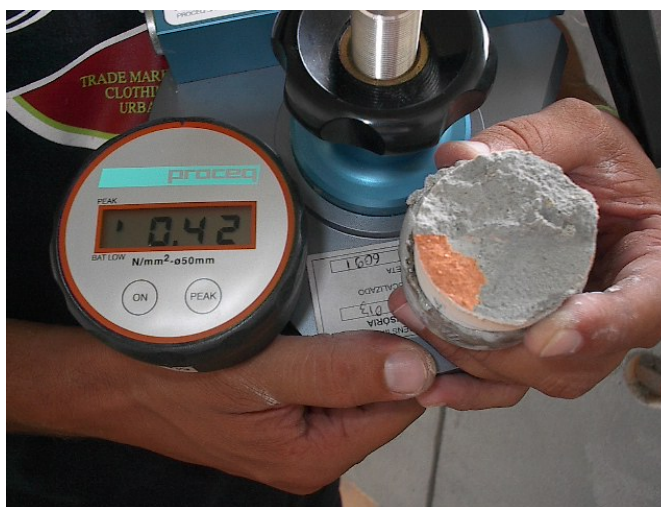
FIGURA 46 - Amostra retirada após teste de resistência à tração.
