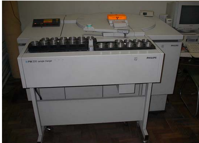
FIGURA 5 - Aparelho para a realização da espectrometria de fluorescência de raios-X (FRX).
