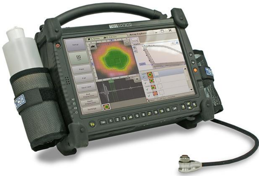
FIGURA 2.25 – Imagem do Ensaio Com o Ultrassom Multiponto FONTE: TESSONICS.*
