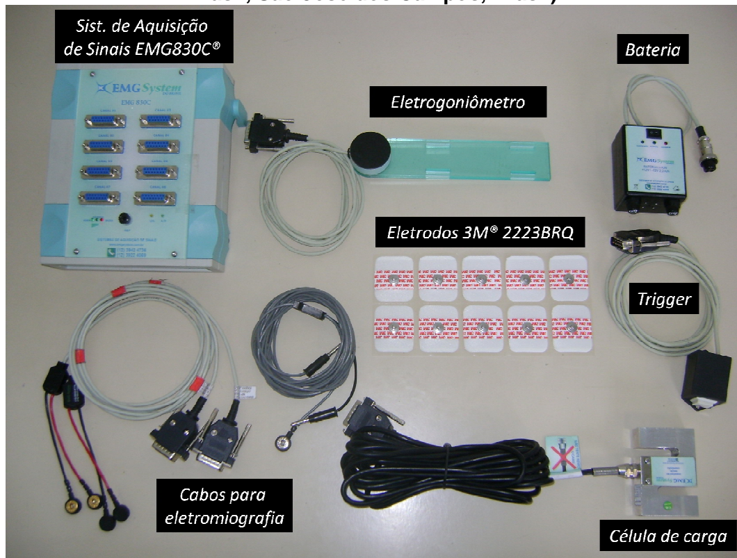
Figura 13. Sistema de aquisição de sinais e sensores (EMG System do Brasil, São José dos Campos, Brasil).
