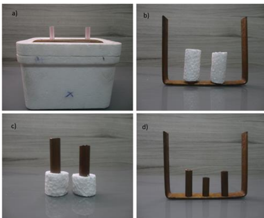
Figura 4.6: Aparatos utilizados no (a) resfriamento unidirecional com LN2, (b) resfriamento unidirecional realizado no freezer, (c) resfriamento radial e (d) resfriamento bidirecional.
