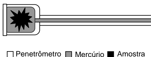
Figura 4.2 - Representação esquemática do penetrômetro com a amostra e mercúrio.
