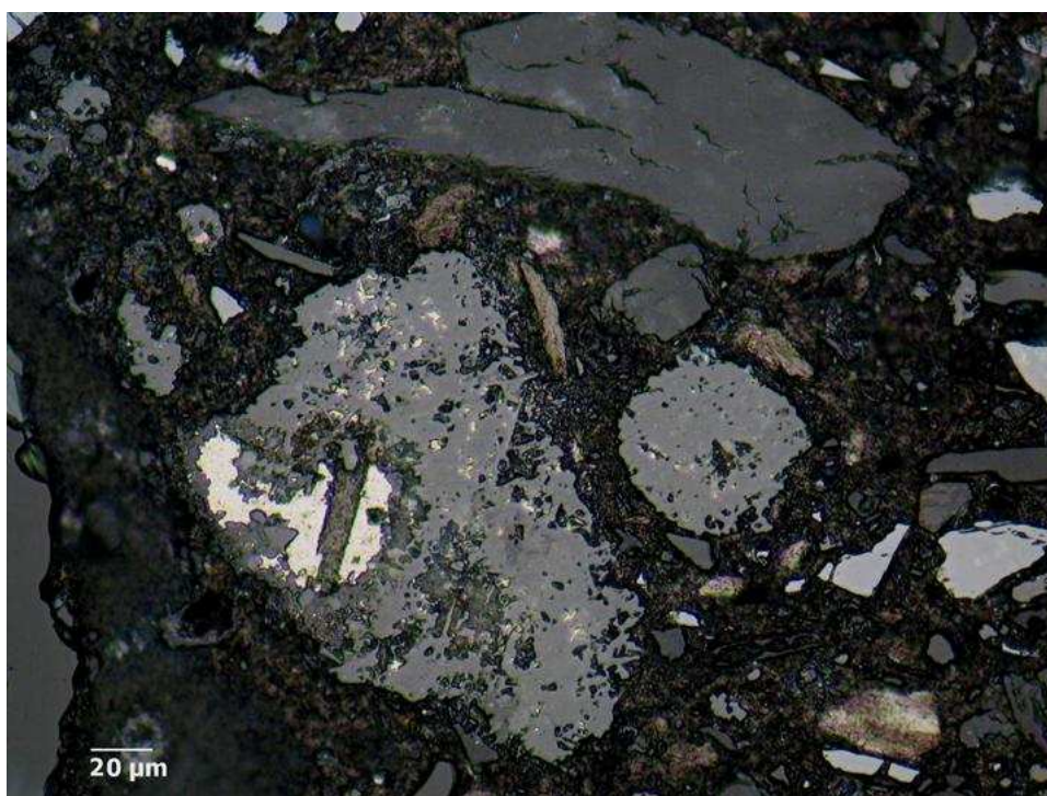
Figura 5.42 - Fotomicrografia sob luz polarizada da massa de tamponamento M1 tratada termicamente à 1400°C: a) aumento de 200x; b) aumento de 500x.
