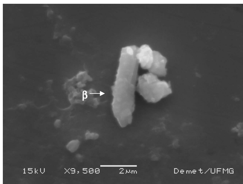
Figura 5.15 - Fotomicrografias evidenciando a fase \beta - \text{Si}_3\text{N}_4 : a) nitreto de ferro silício A; b) nitreto de ferro silício B.
