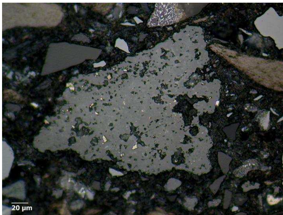
Figura 5.40 - Fotomicrografia sob luz polarizada da massa de tamponamento M1 tratada termicamente à 1200°C: a) aumento de 200x; b) aumento de 500x.
