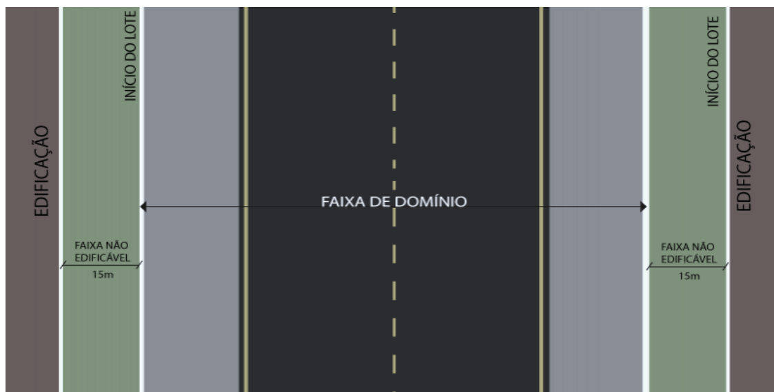
Figura 3. 24 – Desenho esquemático da faixa de domínio de uma rodovia
