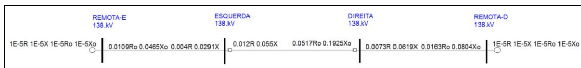
Figura 5.1: Sistema elétrico modelado no software OneLiner®.
