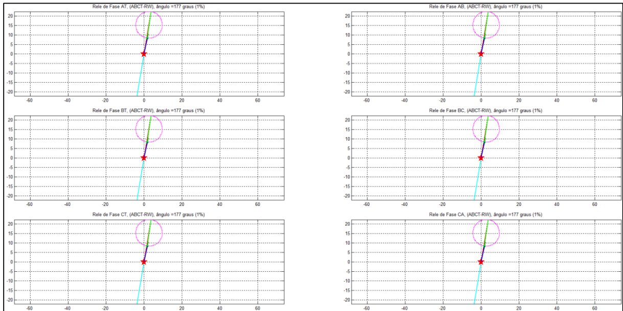
Figura 5.82: Relé Mho polarizado por memória sob curto-circuito trifásico, a 1% da LT reversa ( R_F = 0 \Omega ).
